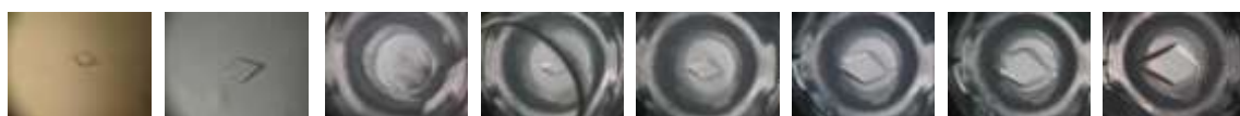
マクロシーディングと試料逐次添加による ADPRase 結晶の大型化 (例)
