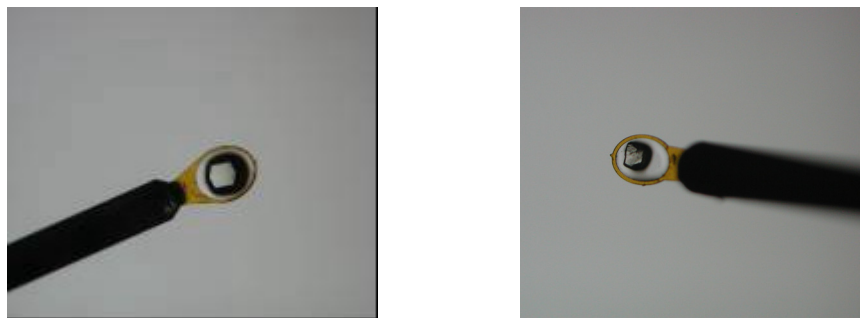
図 10 LithoLoops を用いた結晶のマウント（ループ径は共に 0.4mmφ）
