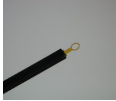
(d) マイクロチューブに実装 （ループ径 0.4mm \phi ）
