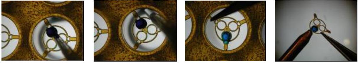
(a) 蛋白質を分注する (b) 沈殿剤をウェルから (c) 結晶化後 MOS を (d) ピンに実装する 取り出し分注する 取り出す
