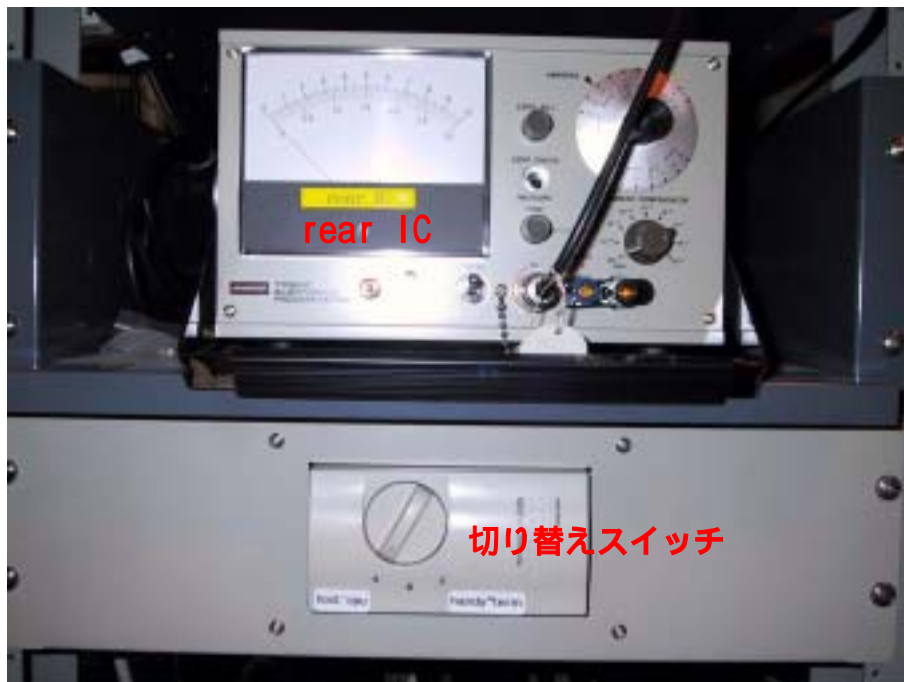
FIG. 3 イオンチャンバーの電流計とハンディターミナルの切り替えスイッチ
