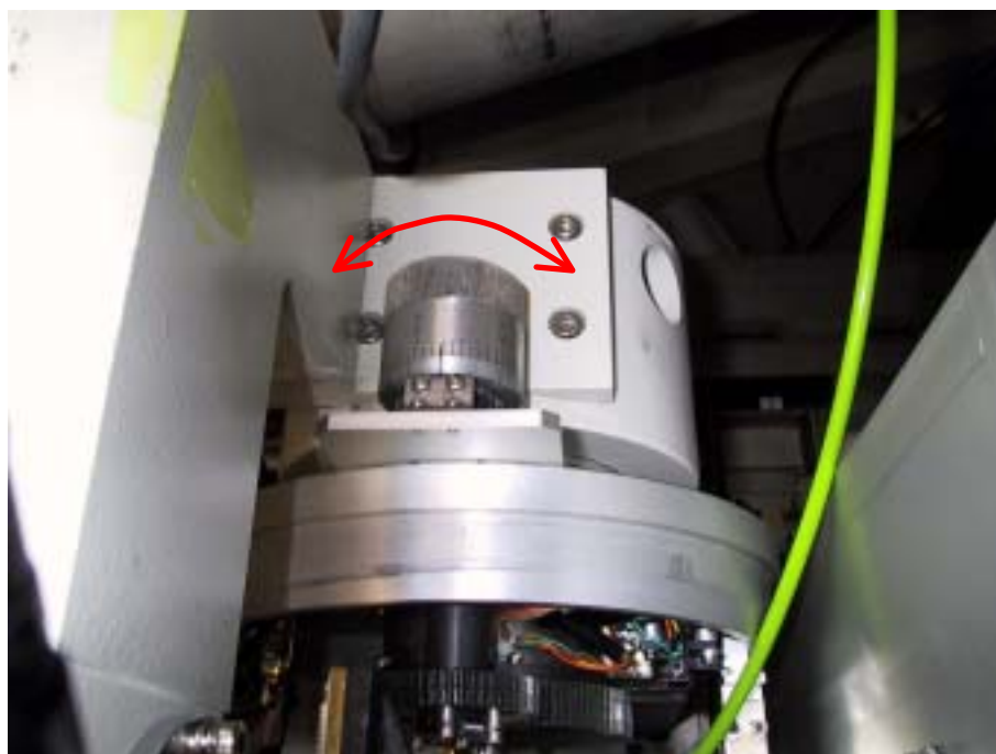
FIG. 8 Z軸の調節はZ軸を動かす度にビームを通し、rear ICの値を見ながら行う
