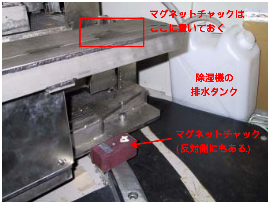
FIG. 1 マグネットチャックをはずしたらカメラの移動の邪魔にならないところに置いておく
