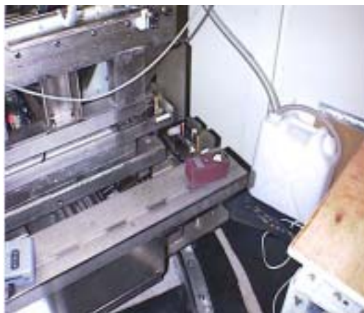
Fig.2 2 固定ブロックをはずす
