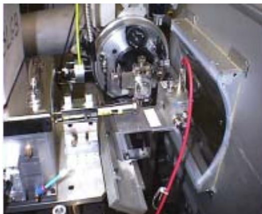
Fig.1 コリメータ、イオンチャンバ取り付け
