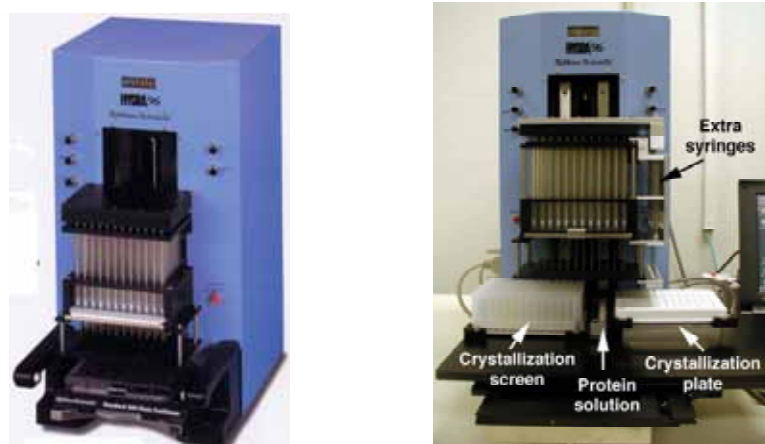
図 1 . Hydra-96 分注機 . (左) 改造前 , (右) 改造後 .
