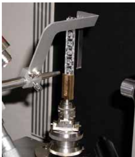
図 1 2 . 新結晶化プレートをマウントアダプタでマウントした様子 .
